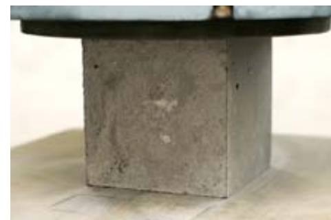
BETON PŘI ZKOUŠCE PEVNOSTI V TLAKU
