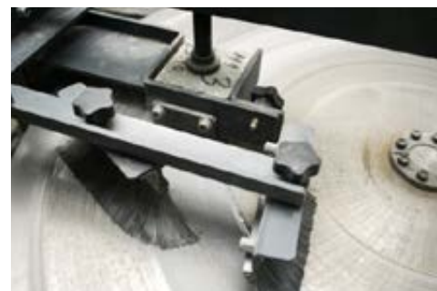
DLAŽBA PŘI ZKOUŠCE OBRUSNOSTI POVRCHU
