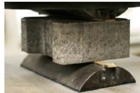
DLAŽBA PŘI ZKOUŠCE PEVNOSTI V PŘÍČNÉM TAHU
