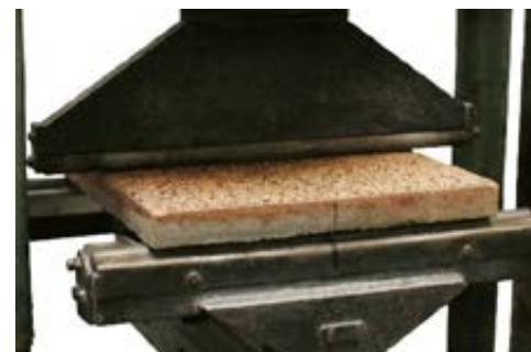
DLAŽBA PŘI ZKOUŠCE PEVNOSTI V OHYBU
